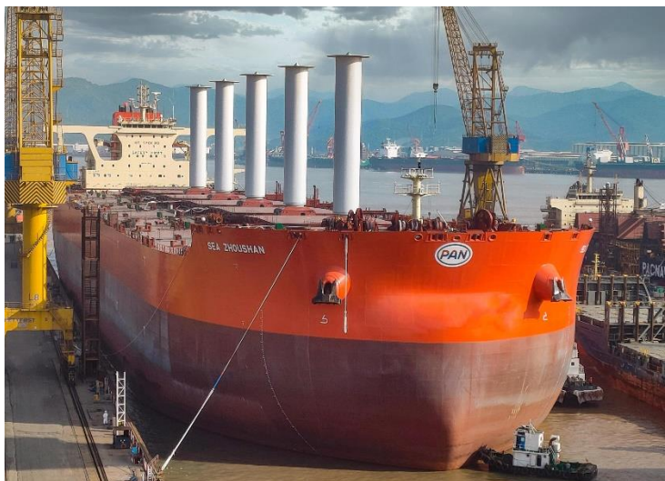
Εικόνα 1.2. Φορτηγό πλοίο της εταιρίας Vale με 5 Flettner Rotors
