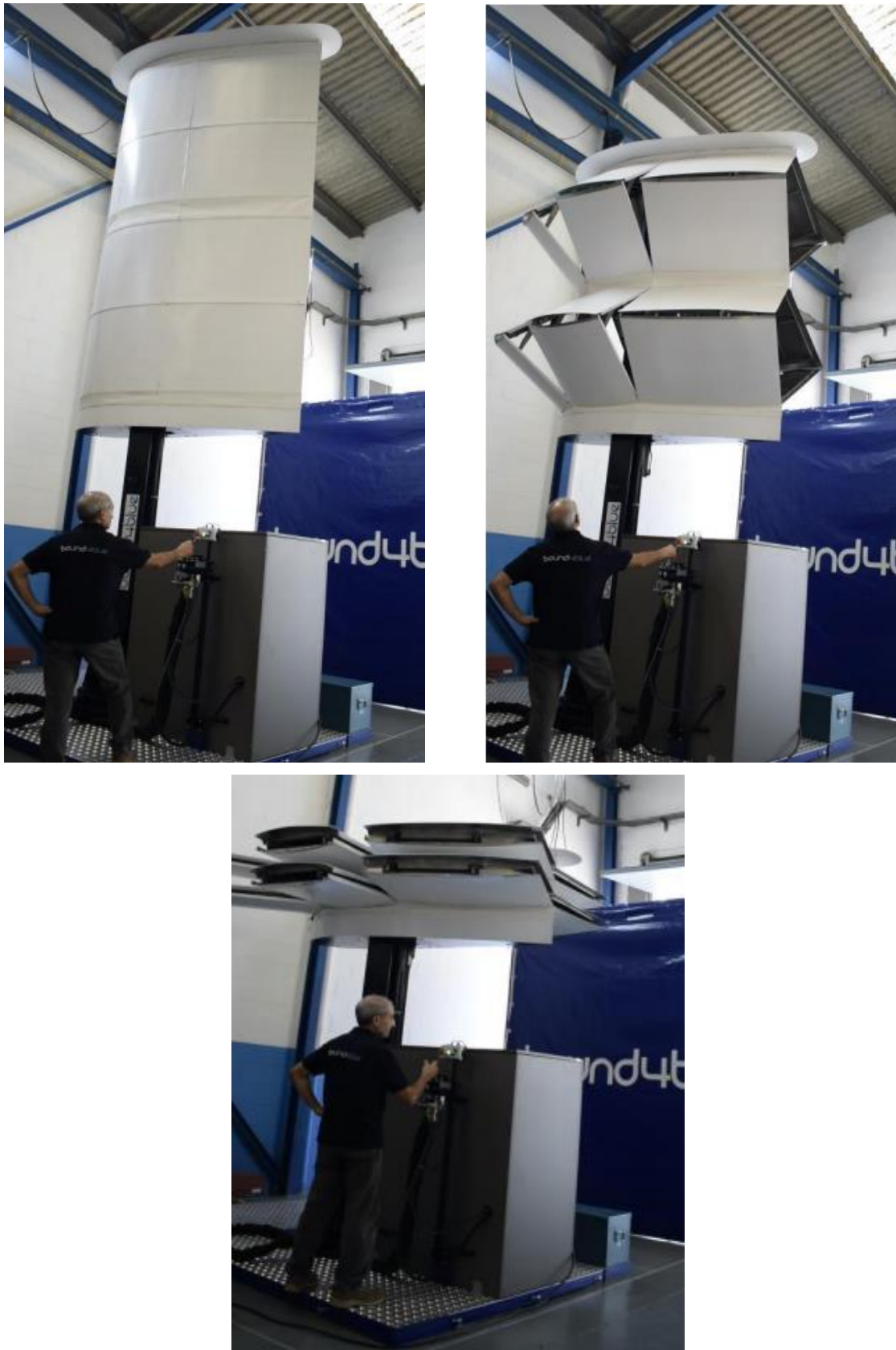
Εικόνα 1.11. Διαδικασία αναδίπλωσης wingsail της εταιρείας Bound4Blue (πηγή: [4])
