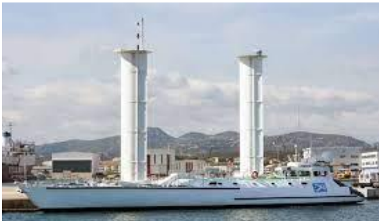
Εικόνα 1.4. Το πλοίο 'Alcyone' του Cousteau με 2 Turbosail
