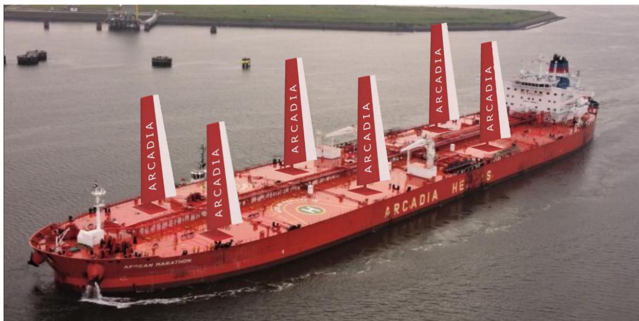
Εικόνα 4.8. Το Aegean Marathon με εγκατεστημένη την βέλτιστη διάταξη ιστίων
