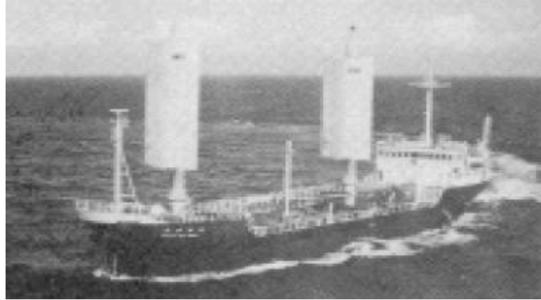
Εικόνα 1.6. Το tanker 'Shin Aitoku Maru' με 2 wingsails, 1980
