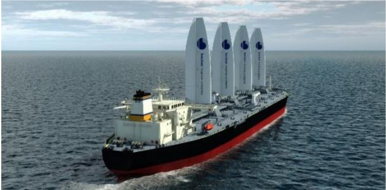
Εικόνα 1.9. Δεξαμενόπλοιο με 4 wingsails: Concept της εταιρίας Becker Marine Systems
