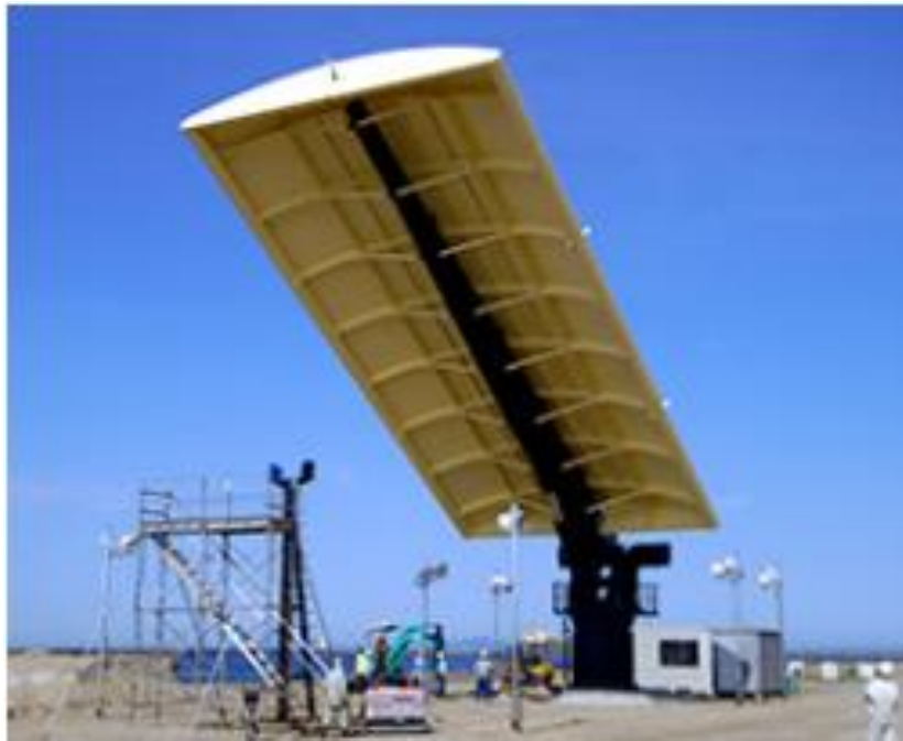
Εικόνα 3.12. Προτότυπο wingsail της εταιρείας TOKYO-Mitsui O.S.K., Ltd. (πηγή: [32])
