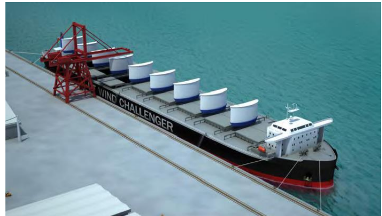
Εικόνα 1.8. Το concept πλοίου Wind Challenger εφοδιασμένο με 9 τηλεσκοπικά ιστία πλήρως κλειστά στο λιμάνι
