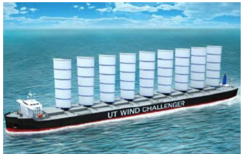
Εικόνα 1.7. Το concept πλοίου Wind Challenger εφοδιασμένο με 9 τηλεσκοπικά ιστία πλήρως ανεπτυγμένα στη θάλασσα
